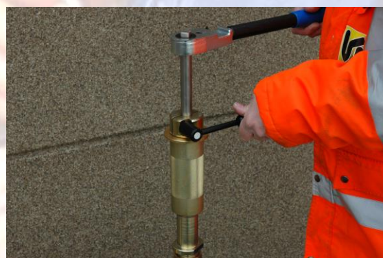
22. Draai als de spil geheel is teruggetrokken de knevel weer aan.
