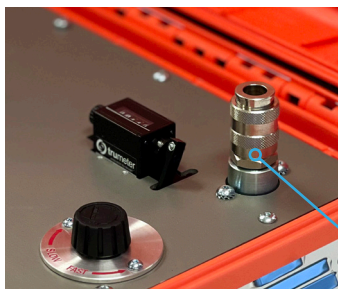
Luchtaansluiting Air inlet location
