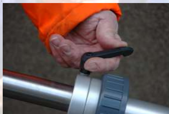
18. Vergrendel de zakpijp door de knevel aan te draaien.
