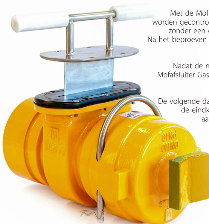
Mofafsluiter Gas met eindkap. De eindkap is voorzien van een inwendige draadopname waarop een ontluuchtingsset of - zoals op de foto - een stootblokje voor het stootijzer kan worden gemonteerd.
